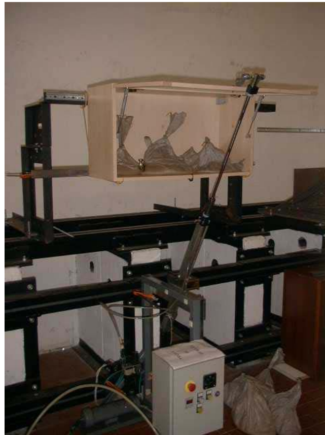
Fotografia 1: prova di durata delle porte
