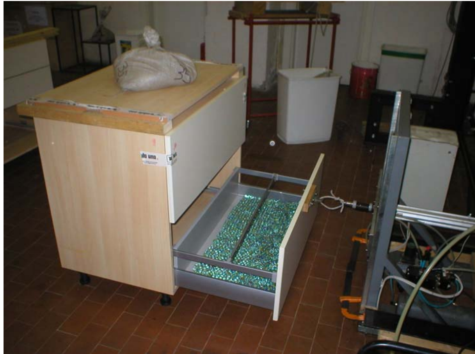
Fotografia 1: prova di apertura con urto dei cassetti
