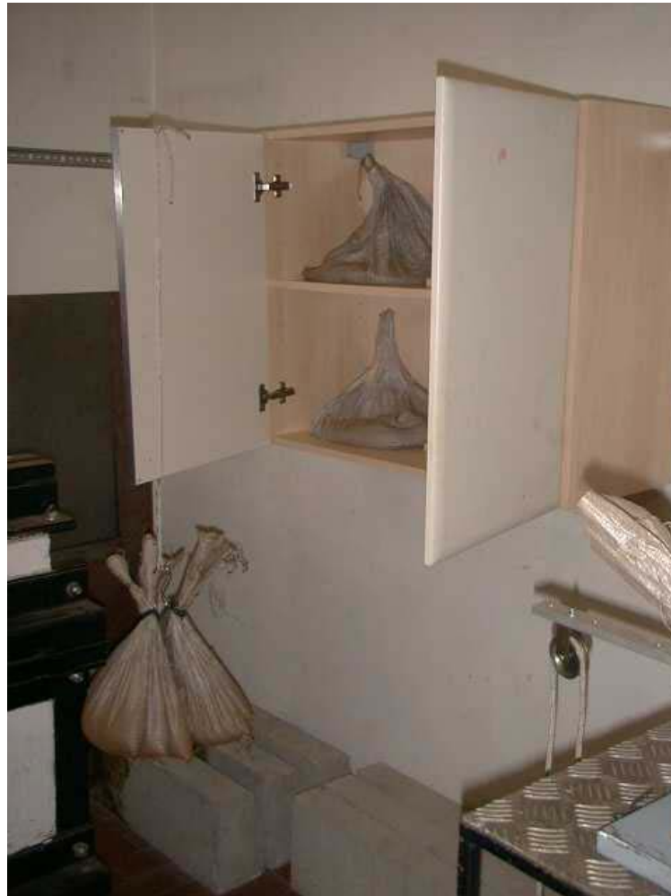
Fotografia 1: prova di carico di porte con cerniera su asse verticale – anta Krea
