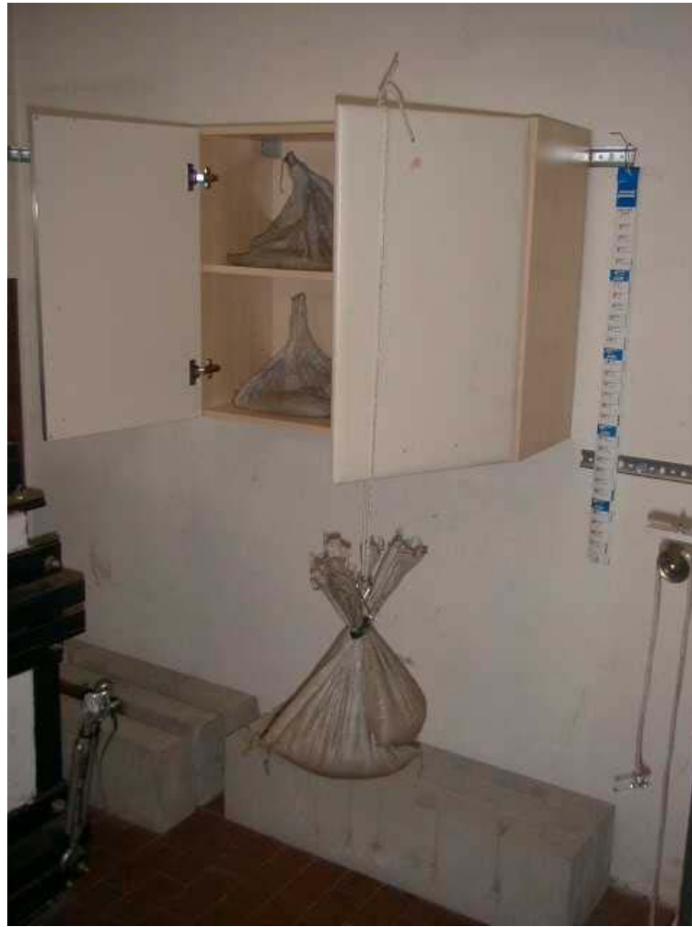
Fotografia 2: prova di carico di porte con cerniera su asse verticale – anta Orma
